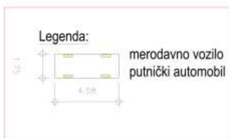
Слика 1. – Димензије меродавног путничког аутомобила
